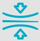
As chapas alveolares Glanze podem ser perfeitamente curvados a frio na direção longitudinal. Os raios de curvatura variam entre 750 e 1500 mm, dependendo da espessura da chapa. Graças à versatilidade de seus formatos, são ideais tanto para aplicações curvas quanto planas.
