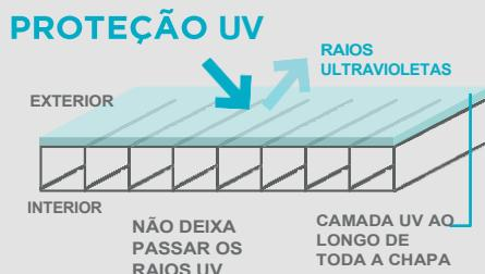
As chapas alveolares Glanze incorporam uma camada coextrudada de proteção UV, aplicada de forma uniforme em toda a superfície e com a porcentagem ideal para evitar o amarelecimento e a perda de luminosidade ao longo do tempo. Graças a essa tecnologia, garantem alta durabilidade e possuem 10 anos de garantia sobre a transmissão de luz.
